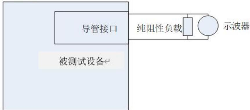
图 1- 脉冲双极输出测试电路
